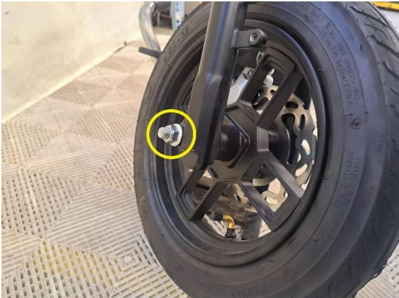
Irrota etuakselin lukitusmutteri (kiintoavain 14 mm, 17 mm).
