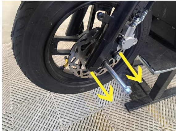
Vedä etuakseli pois. Kannattele etupyörää samalla, ettei pyörä pääse putoamaan hallitsemattomasti pois paikoiltaan.
