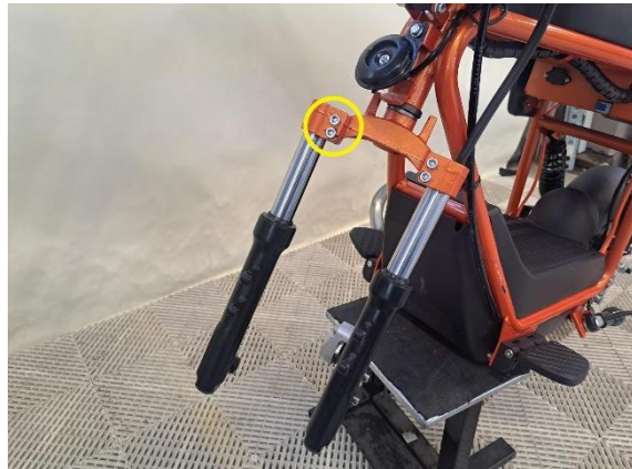
Löysää oikean etujousen kiinnityspultit (kuusiokoloavain 6 mm).
